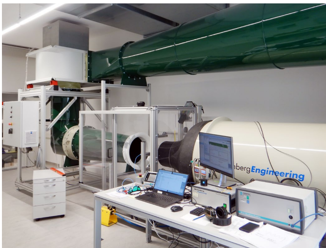
Windkanal für die Kalibrierung der Strömungsgeschwindigkeit
