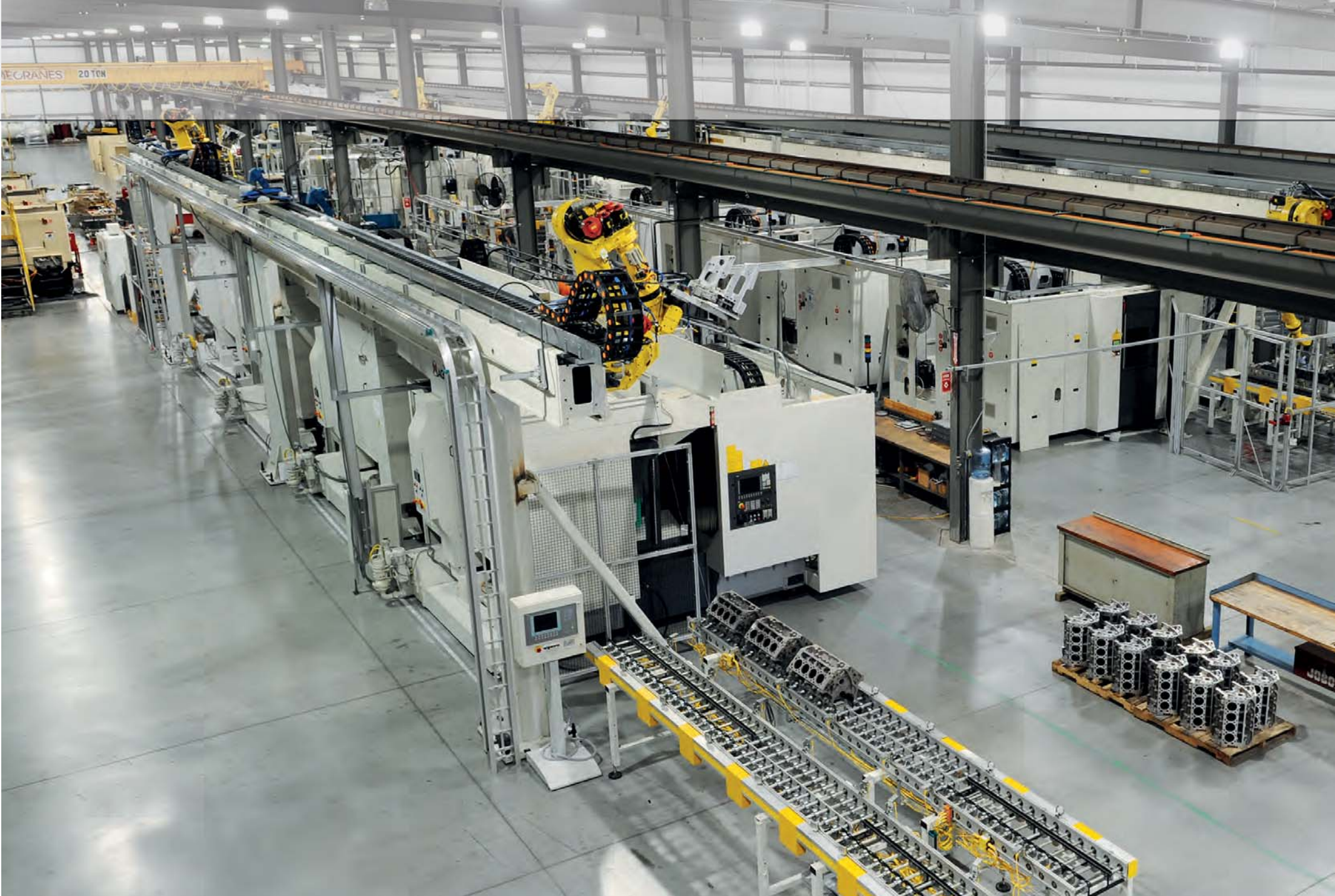
Retooling einer kompletten Fertigungslinie für Zylinderkurbelgehäuse.
