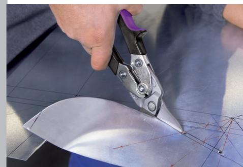
**Handblechscheren mit Hebelübersetzung**
