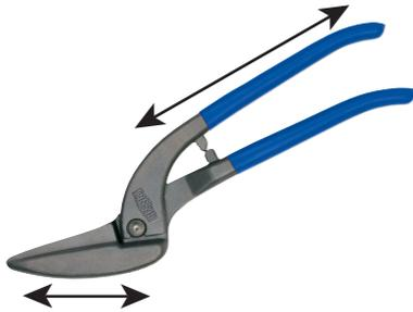
Bei Normalblechscheren sind traditionell Schneide und Griff in einem Stück geschmiedet. Die Schneidkraft ergibt sich aus dem Verhältnis Schneidenlänge zu Grifflänge.
