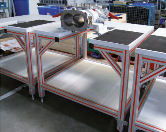
Montagelinie für Pumpen aus Profilsérie 50 mit geschlossenen Profilnuten über Verschlussprofil rot
