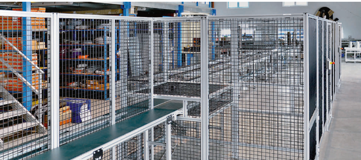
Schutzeinrichtung mit Schweißgitter (Feld-Lösung) für Tray-Transportanlage
