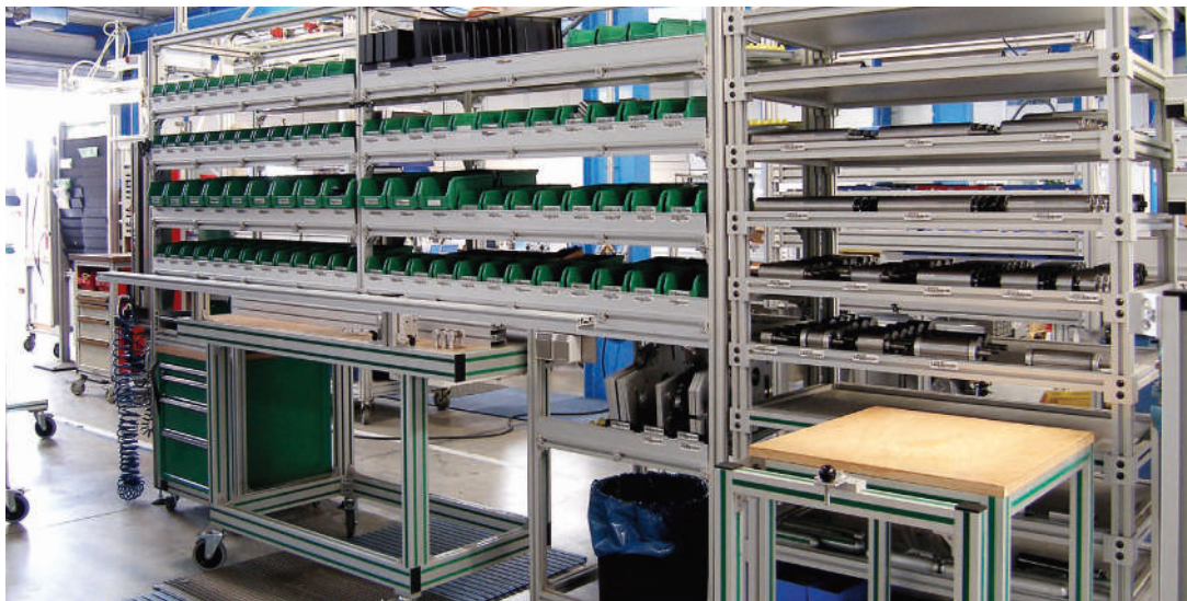
Arbeitsplatz nach „Kanban-Prinzip“ zur produktivitätssteigernden Entkopplung von Montage und Versorgungslogistik
