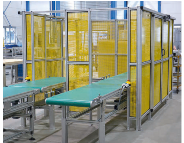
Individuelle Schutteinhausung aus Feldern mit pulverbeschichteten Lochblechen und Schiebetüren mit Sicherheitszuhaltung
