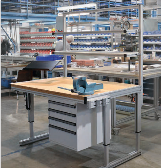
Arbeitsplatz mit elektro-hydraulischer Höhenverstellung und Unterbauschrank
