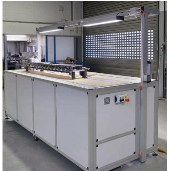
Montagearbeitsplatz mit Absenkvorrichtung über elektrisch angetriebene Hydraulikzylinder
