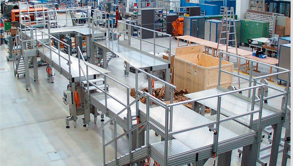
Freitragende Montagebühne, 15 Meter lang, mit Lasttreppen für sicheren Halt bei hohen Belastungen
