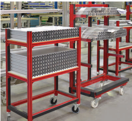
Bereitstellungswagen aus rot lackierten Profilen der Serie 40
