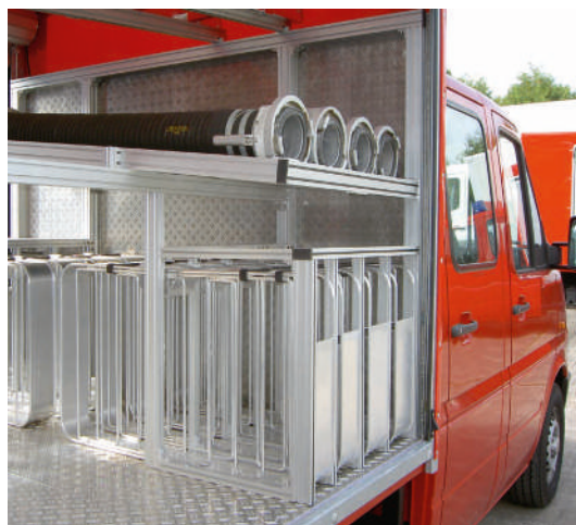
Innenausbau für Feuerwehrfahrzeug aus Profilen der Serie 25
