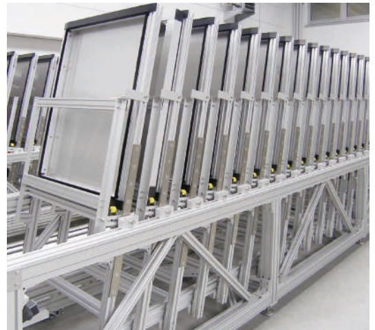
Gestell aus Profilen der Serie 40 einer Anlage zur Beobachtung und Kontrolle von Pflanzenwachstum
