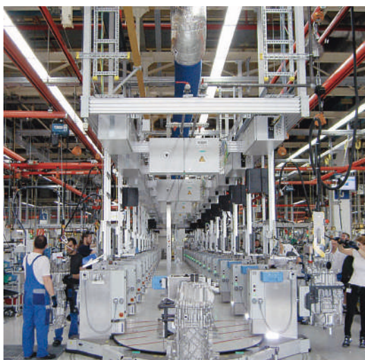
Überbau aus Profilen der Serie 40 als Versorgungsträger für Montagearbeitsplätze
