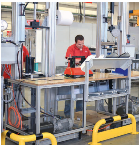
Montagearbeitsplatz mit integrierter Presse und Dokumentenablage
