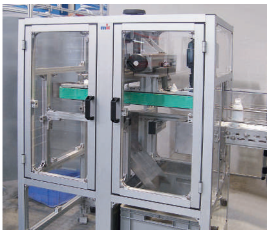
Schutzeinrichtung mit Flügeltüren aus Reinraumprofilen
