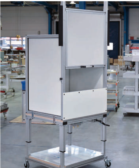
Arbeitsplatz mit Schutzhaube und manuell verfahrbarem Schiebelement
