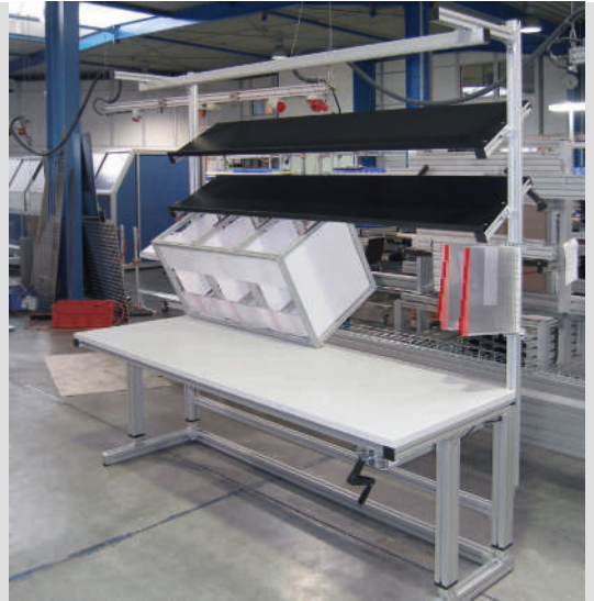
Hydraulisch höhenverstellbarer Arbeitsplatz mit schwenk- und tiefenverstellbarer Blechablage
