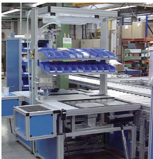
DFT-Fließmontagelinie für Vakuumpumpen
