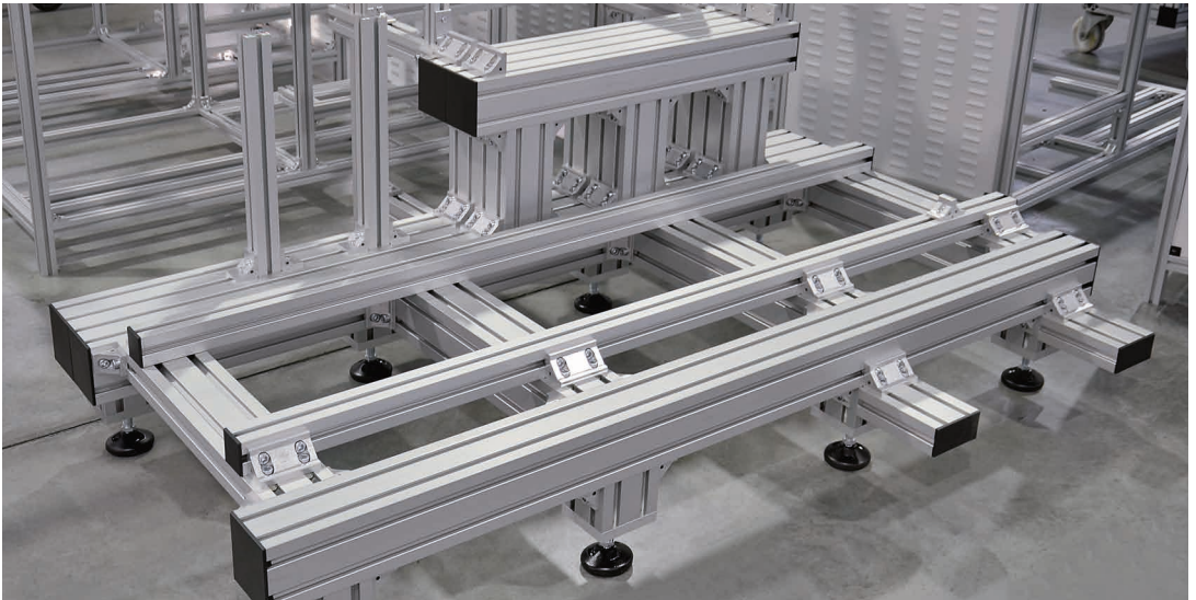
Grundkonstruktion besteht aus Profilen der Serie 40 und 60
