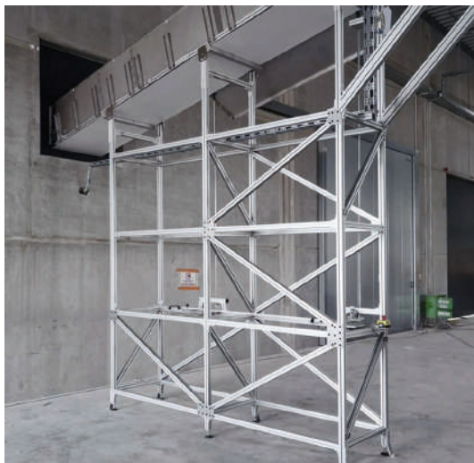
Gestell und Aufhängung für Förderstrecke in 5 m Höhe unter der Hallendecke
