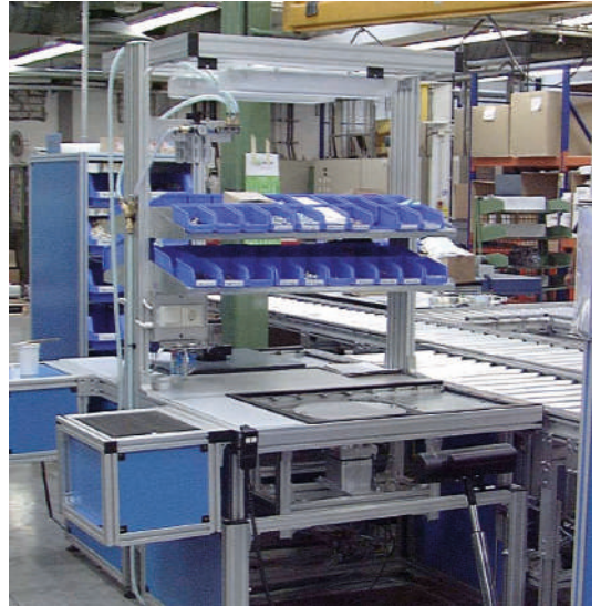
Industriearbeitsplatz in DFT-Fließmontagelinie für Vakuumpumpen
