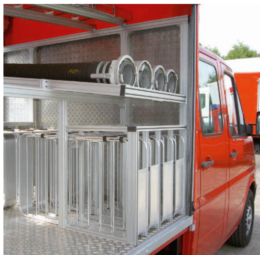
Innenausbau für Feuerwehrfahrzeug aus Profilen der Serie 25
