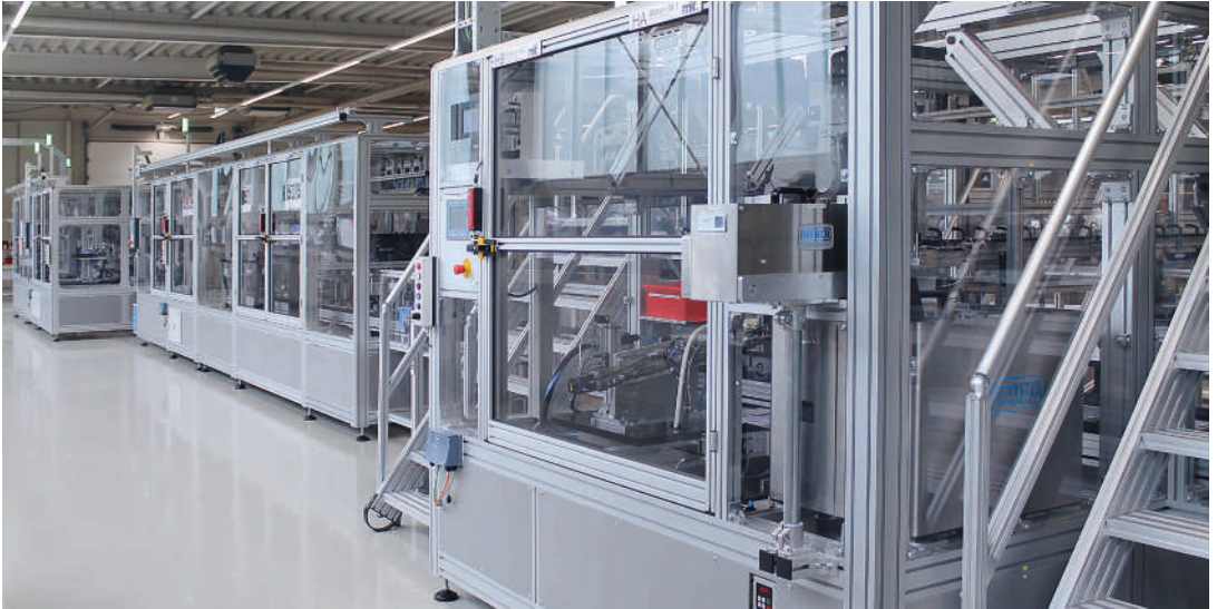
Schutzeinhausung für 45 Meter lange Montageanlage mit Durch- und Übergängen für die Wartung
