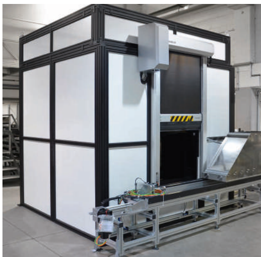
Messkammer aus schwarz eloxierten Profilen mit automatisierter Zu- und Abführung
