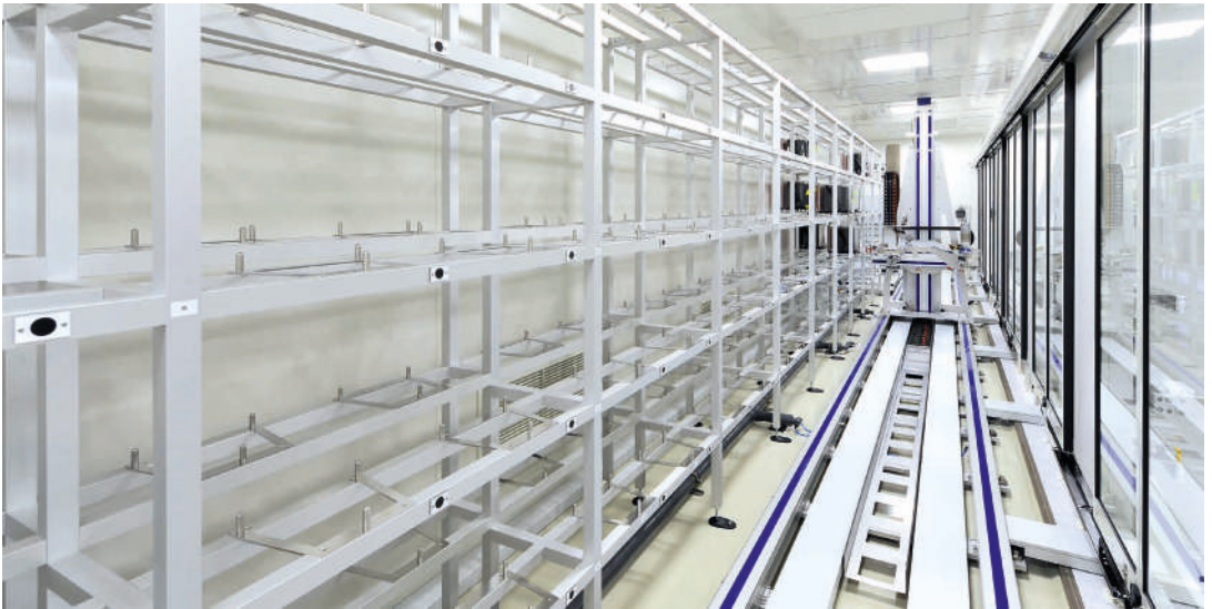
Reinraumlager incl. Regalbediengerät und Übergabestationen aus mk Reinraumprofilen der Serie 40
