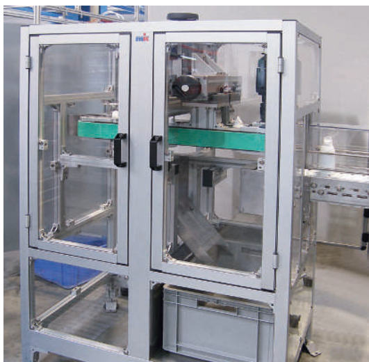
Schutzeinrichtung mit Flügeltüren aus Reinraumprofilen
