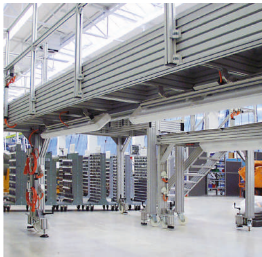
Die Profalnuten eignen sich für die Anbindung von Komponenten, wie z.B. der Elektronikversorgung
