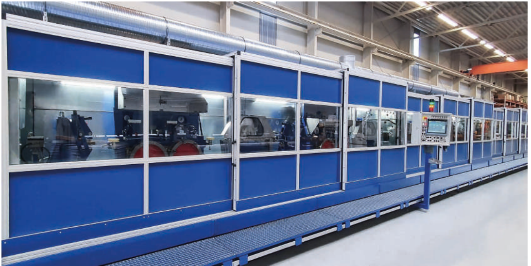
Verfahrbare Maschineneinhausung aus Profilen der Serie 50 für Bandwalz-Anlage
