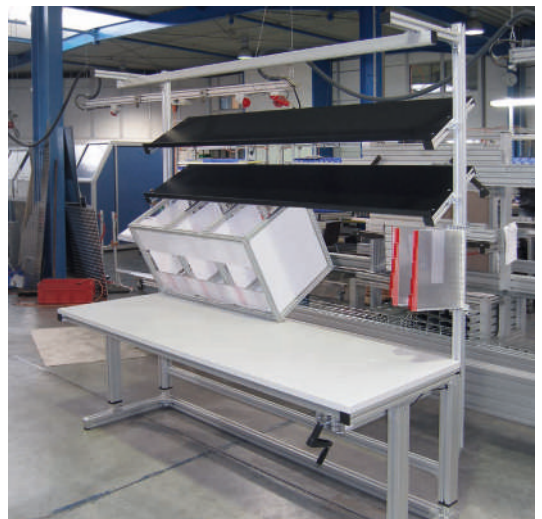
Hydraulisch höhenverstellbarer Arbeitsplatz mit schwenk- und tiefenverstellbarer Blechablage
