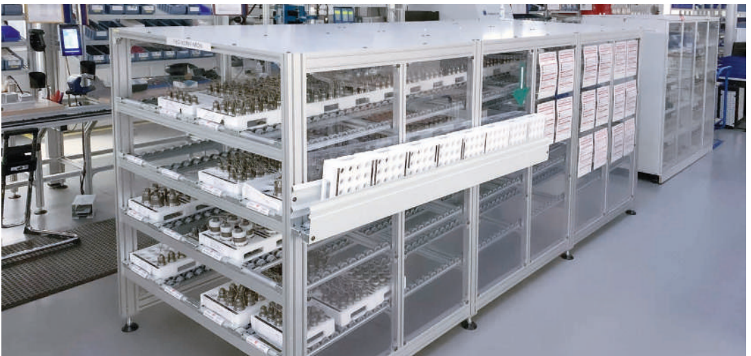
Bereitstellungs-Regal nach FiFo-Prinzip (First in - First out) mit Rollenleisten
