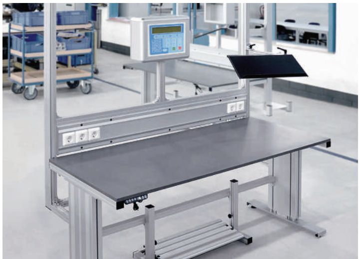
Arbeitstisch J1 mit integrierter Elektroversorgung, Fußstütze und kundenspezifischem Monitorhalter
