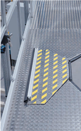
Montageklappe im Podestboden mit Antirutschbelag
