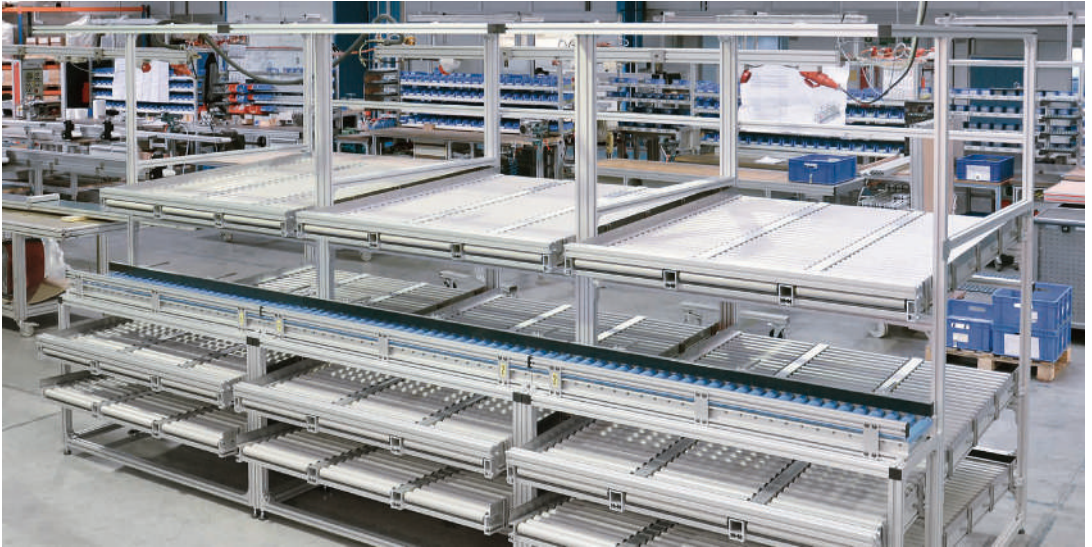
Kanban Systemarbeitsplatz – zur manuellen Produktentnahme und Kommissionierung
