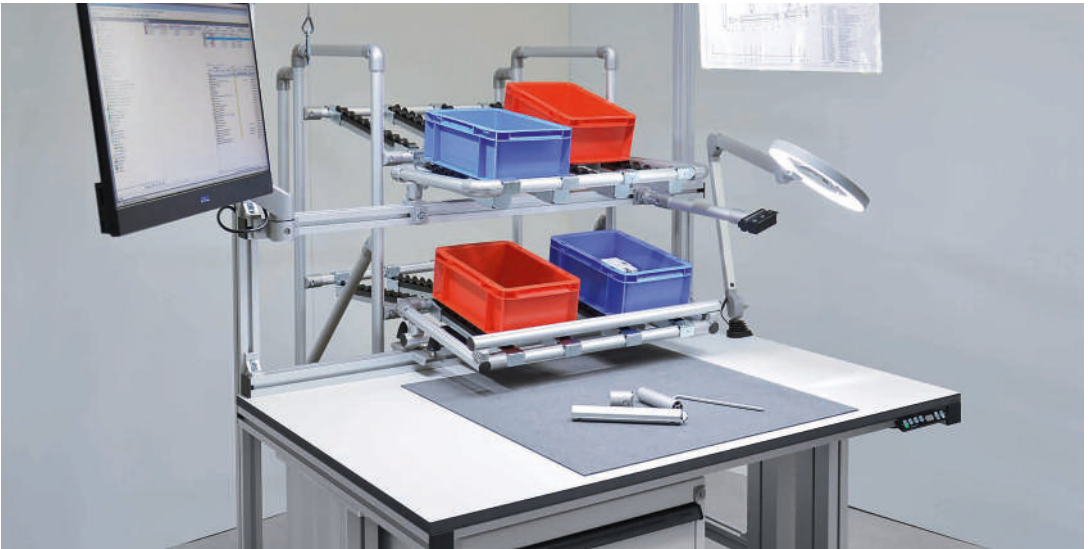
Höhenverstellbarer Arbeitsplatz mit Monitor, Lupenleuchte und Materialbereitstellung über separaten Bereitstellwagen
