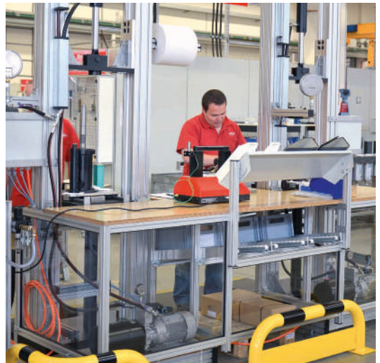
Montagearbeitsplatz mit integrierter Presse und Dokumentenablage
