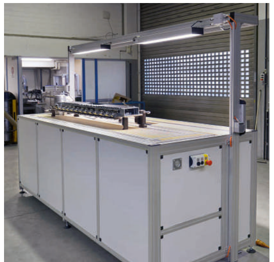
Montagearbeitsplatz mit Absenkvorrichtung über elektrisch angetriebene Hydraulikzylinder
