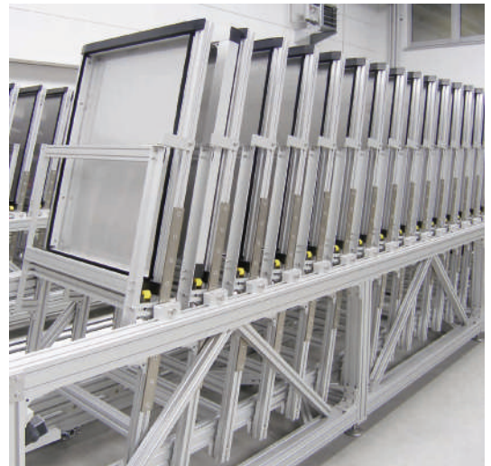
Gestell aus Profilen der Serie 40 einer Anlage zur Beobachtung und Kontrolle von Pflanzenwachstum
