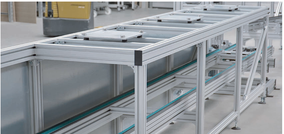
Grundgestell mit Stellfüßen und mit Werkstückträger-Aufnahmen
