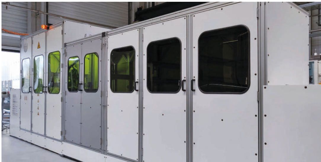
Laserschutzkabine mit Labyrinth-Dichtungen für Automatisierungslinie
