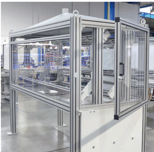
Aufladeeinheit für die Vliesfertigung mit Wartungstür und Absaughaube
