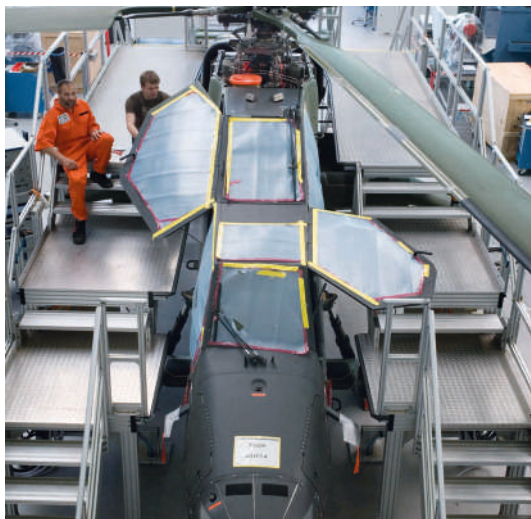
Mobile Montagebühne für Helikopter mit unterschiedlichen Ebenen und mehreren Aufgängen
