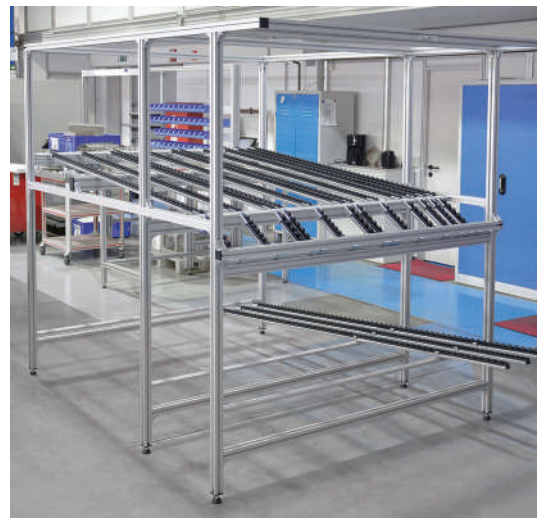
Kanban-Regal für Materialzufuhr über Röllchenbahnen und Leerkistenrücklauf
