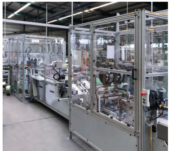
Retrofitting einer Produktionslinie mit Schutzeinhausungen
