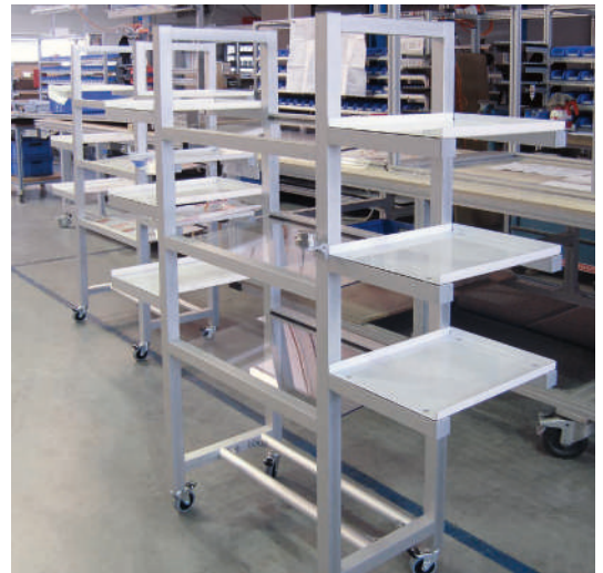
Materialbereitstellungswagen aus Reinraumprofilen der Serie 40 inkl. Acrylablagen
