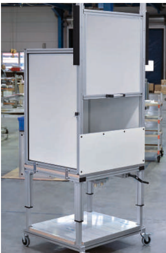
Arbeitsplatz mit Schutzhaube und manuell verfahrbarem Schiebelement
