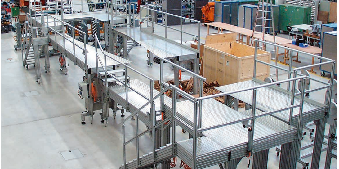
Freitragende Montagebühne, 15 Meter lang, mit Lasttreppen für sicheren Halt bei hohen Belastungen
