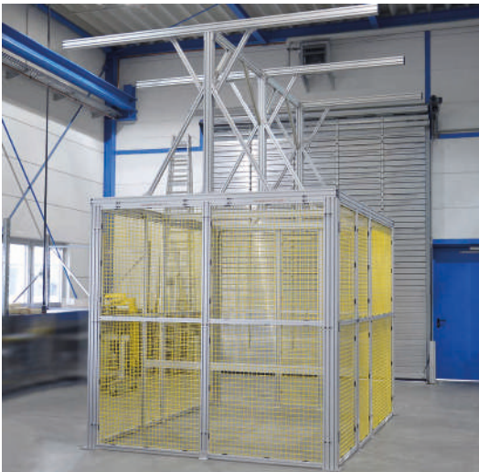
Schutteinrichtung für Übergabestation mit Auslegern zur Montage einer Hängebahn
