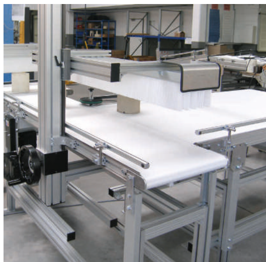
GUF-P 2000 mit integrierter Verstelleinheit (VST 2011) zur Höhenverstellung der Abstreiferbürsten
