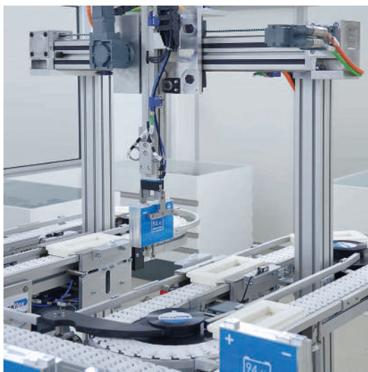
Zwei-Achs-Portal mit Servomotoren und individuellem Greifer in Kombination mit Versaflex Scharnierbandförderer
