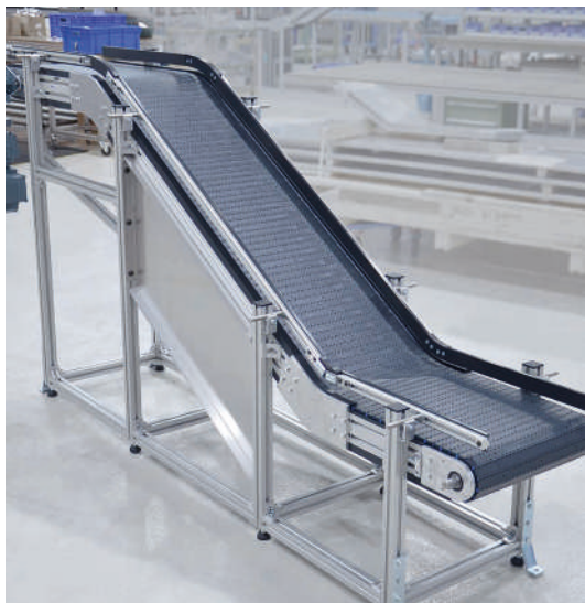
Knickförderer KFM-P 2040 mit Seitenführung, Führungsleiste Typ 22
