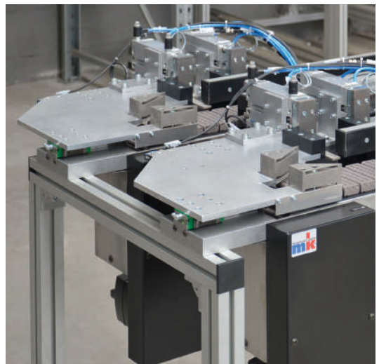
Zweispurige Zuführung zur Maschinenbeschickung. Die Einstellung der Vereinzelung für verschiedenen Durchmesser erfolgt über eine Kugelumlauführung
