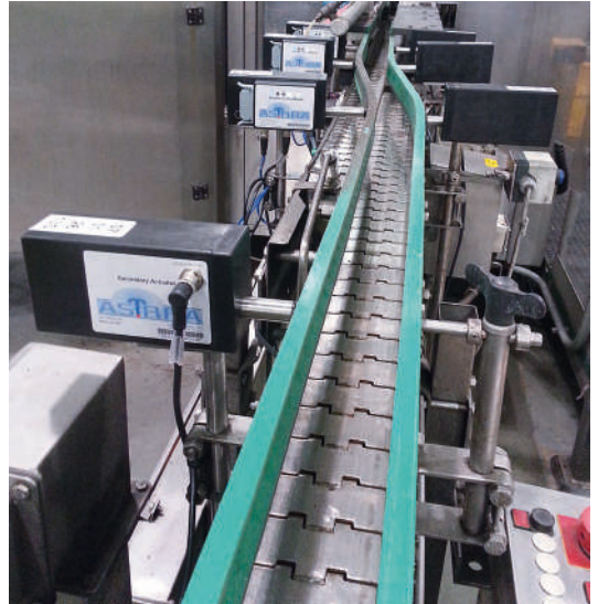
Versaflex Edelstahlförderer mit automatisch verstellbarer Seitenführung ASTRA
