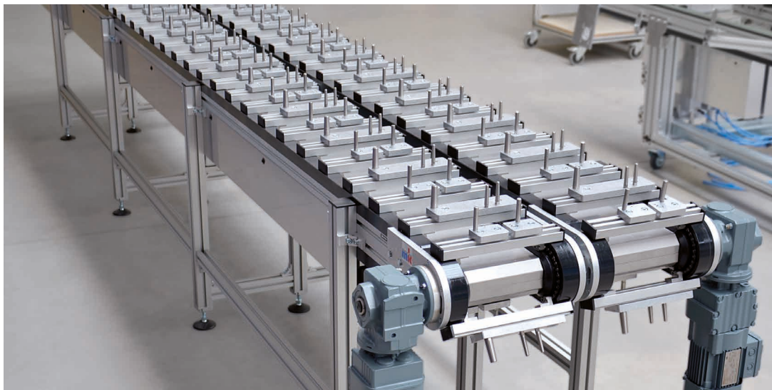
TKU als Zweistrang-System mit auftragsspezifischen Profil-WTs und Aufnahmen
