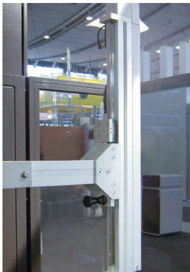
Elektromotorische VST 2015 mit Kugelumlaufführung
