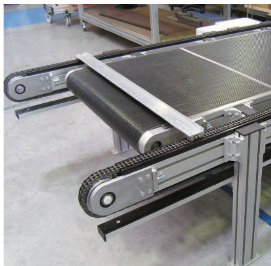
Kombination aus Gurt- und Kettenförderer mit Querschleife zur Simulation eines Bodenhindernisses
