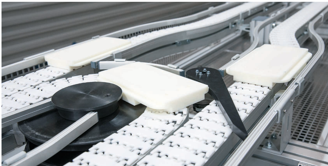
Werkstückträgersystem auf Basis Versaflex SBF A08 mit Weiche
