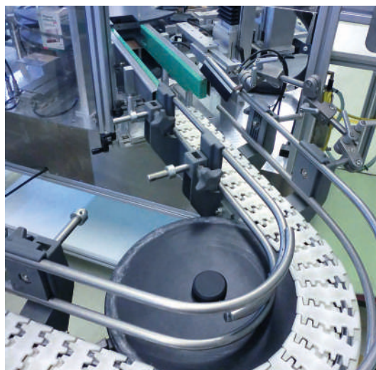
Versaflex Scharnierbandförder mit rollenden Kurven und Seitenführung
