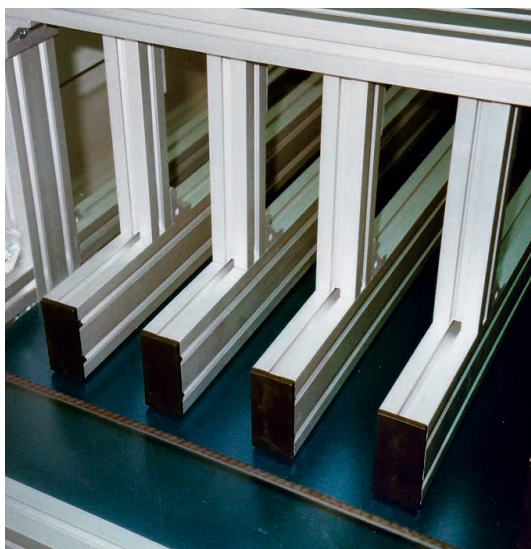
Mehrspurig einstellbare Seitenführung in Portal-Anordnung
