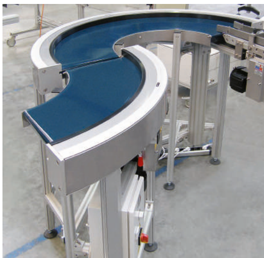
Kombination aus 90° und 180° Kurvengurtförderer KGF-P 2040 mit Untergurtantrieb BI, reversierbar
