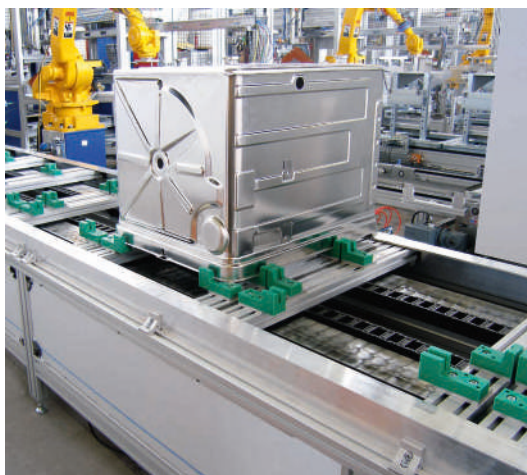
SPU Doppelstrang als Zuführband für Spülmaschinegehäuse
