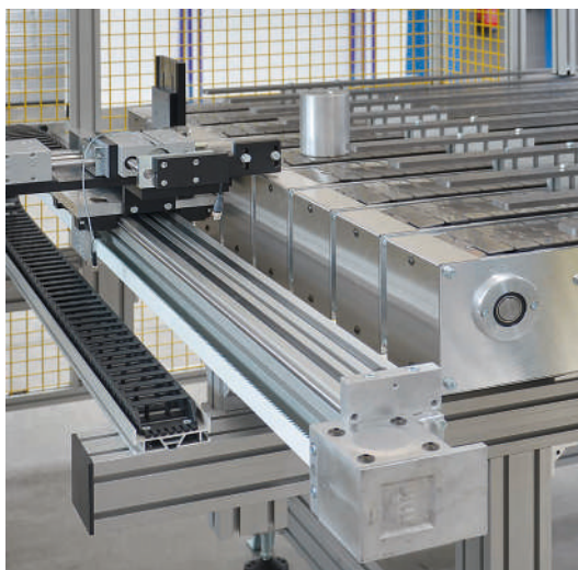
Linearachse aus Linearmodul LZR 2005-38.44-30 mit fahrbarem Greif- und Übergabesystem
