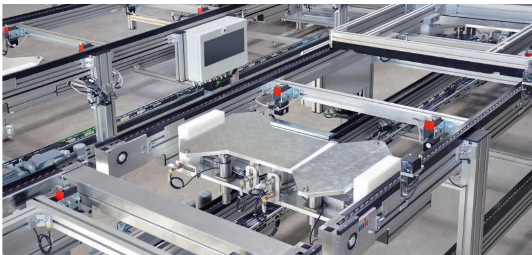
Versamove plus mit Staurollenkettenförderer SRF-P 2010 AF
