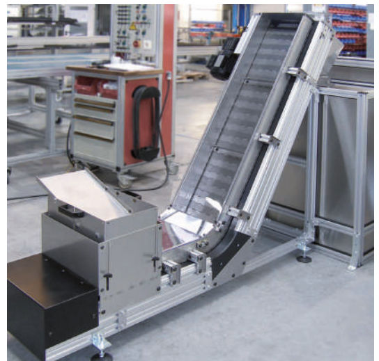
KFM-P 2040.86 SB für heißes Fördergut mit größenveränderbarem Zuführreservoir
