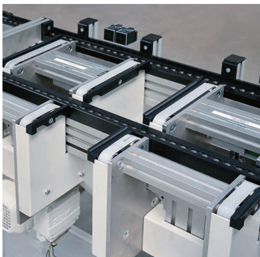
Hub-Querförderer mit gekoppeltem Antrieb und zentralem Hub, zur Überbrückung sehr kurzer Querstrecken
