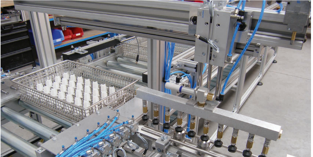
Pneumatisch angetriebenes Linearmodul mit PF 38.77 und LW 38.77-44 als Übersetzeinheit mit 10-fach Greifer über Vakuumsauger
