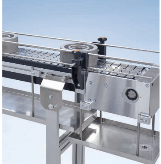
Scharnierbandförderer Sonder in Breite 205 mm mit Auffangwanne und Seitenführung SF10.1
