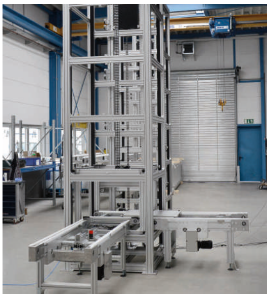
Hublift dreiseitig zugänglich, mit Drehkranz im Fahrkorb und Zuführung über Versamove ultra
