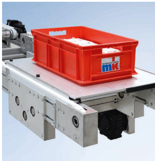
Staurollenkettenförderer SRF-P 2012 mit Sondergleitleisten für höhere Belastung
