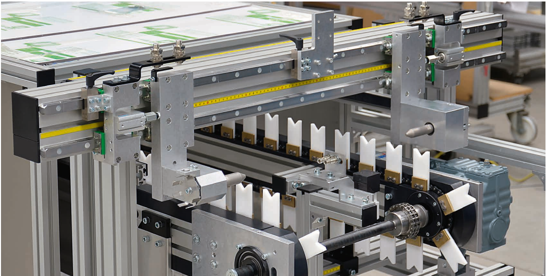
Kettentaktförderer mit Ausrichteinheit für Nockenwellen über Kugelumlauführung
