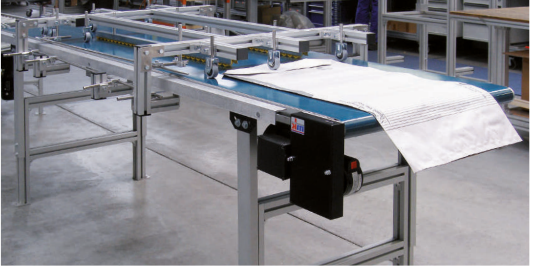
GUF-P 2000 mit Mechanismus zum Falzen und Aufrichten von Papiertüten vor dem Befüllvorgang
