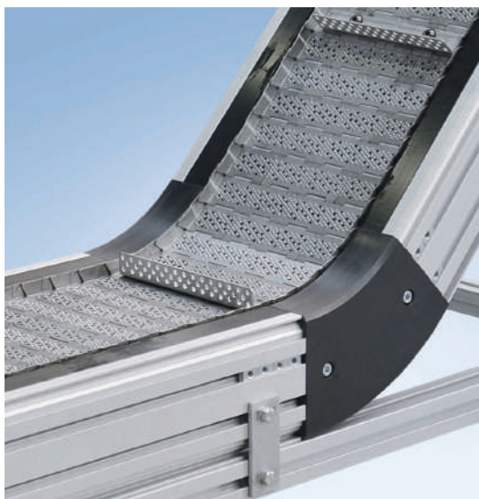
Knickförderer Modulband KFM-P 2040.86 mit gelochtem und genoppten Scharnierplattenband und Mitnehmern
