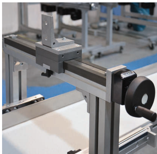
Manuelles 2-Achs-Verstellsystem zur Aufnahme eines Markiergeräts mit VST 2015
