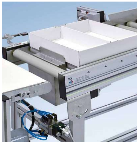
Rollenbahn Schwerkraft RBS-P 2255 mit Vereinzelungseinheit am Rollenbahnauslauf
