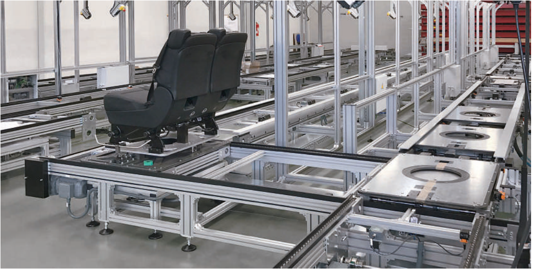
Versamove plus mit großformatigen kundenindividuellen Werkstückträgern
