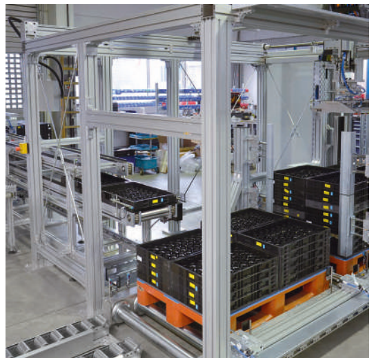
X-Y-Z-Handling Portal zum Ab- bzw. Aufstapeln von Gob-Paletten auf Euro-Paletten
