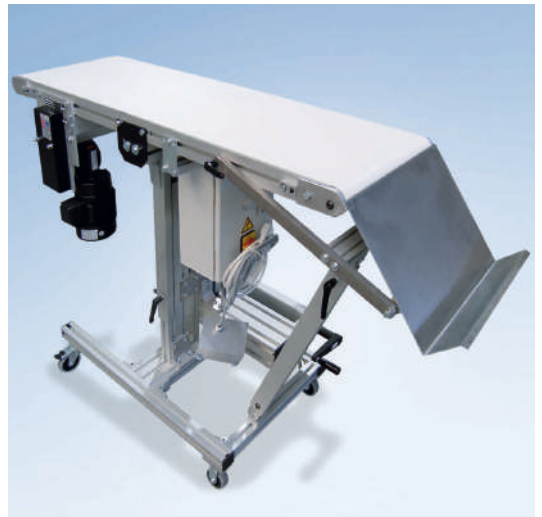
Mobiler GUF-P 2000 mit Entnahmerutsche mit variablem Neigungswinkel
