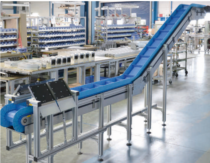
Knickförderer KFM-P 2040 mit Auffangwanne und Ausschleusklappe
