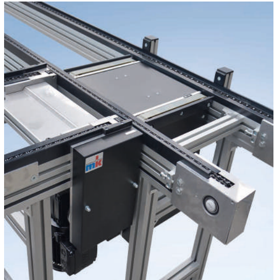
Staurollenkettenträger SRF-P 2010 als WT-Umlaufsystem mit Hub-Querförderer
