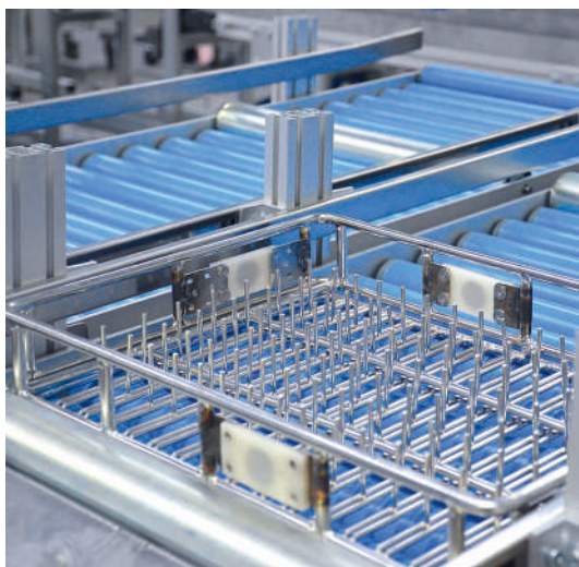
Schwerkraftrollenbahn RBS-P 2065 als Zu- und Abfuhrbahn für Waschkörbe
