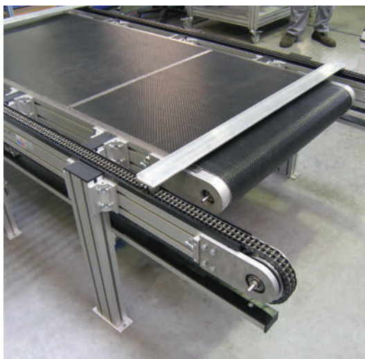
Förderbandkombination aus GUF-P 2004 mit Trommelmotor CA und 2-Strang-KTF-P 2004
