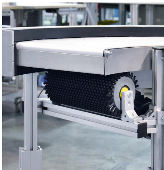
Abstreiferbürste, rotierend, am Bandende montiert
