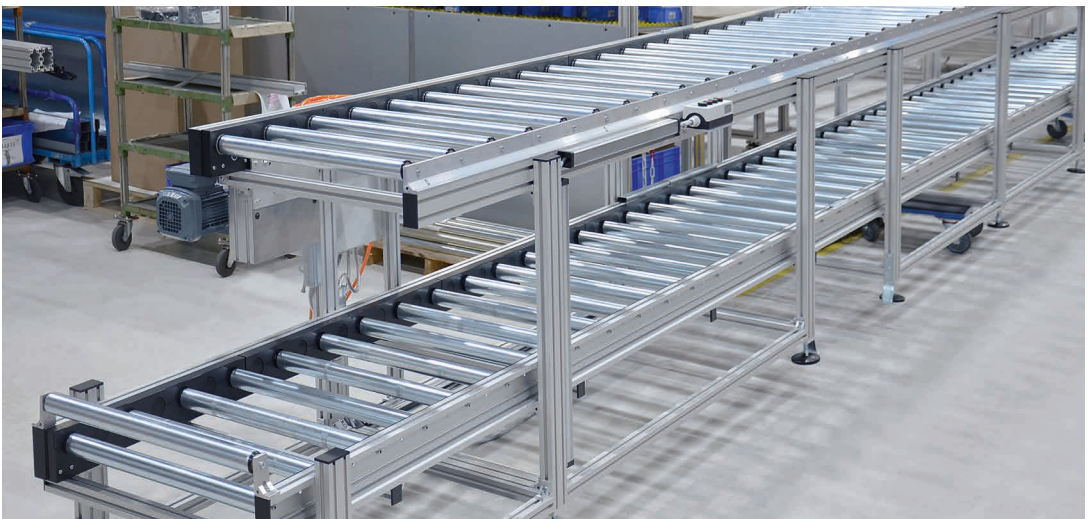
Tangentialkettenrollenbahn RBT-P 2255 für den Stetig- und Staubetrieb von Prüfteilen
