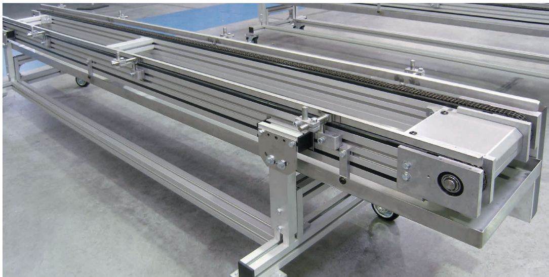
KTF-P 2010 mit Kopfantrieb AC mit Auffangwanne und fahrbarem Unterstell
