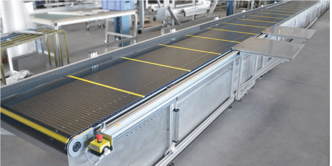
MBF-P 2040 mit optischer Spurtrennung und Arbeitsplatztischen zum manuellen Verschieben an der Strecke
