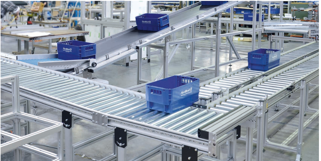
Verkettung mit angetriebenen Rollenbahnen RBM-P 2255 und Schwerkraftrollenbahnen RBS-P 2066 für Postkisten
