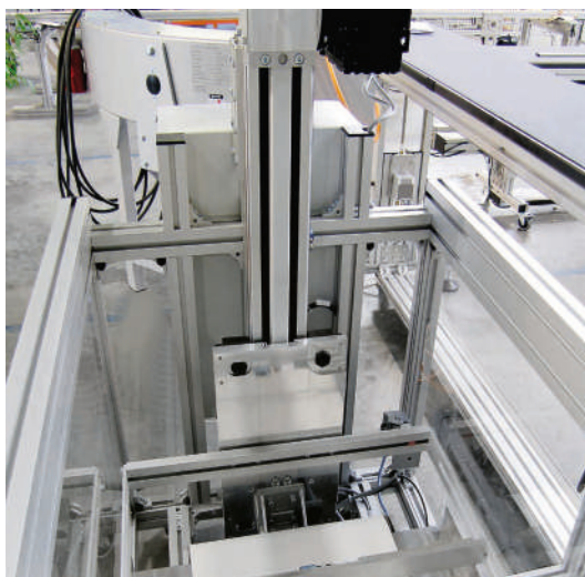
Linearmodul Typ LZR 2005-38.44-30 mit Motor & Steuerung als Hublift mit Gurtförderer
