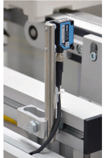
Lichtschranke mit einstellbarem Halter
