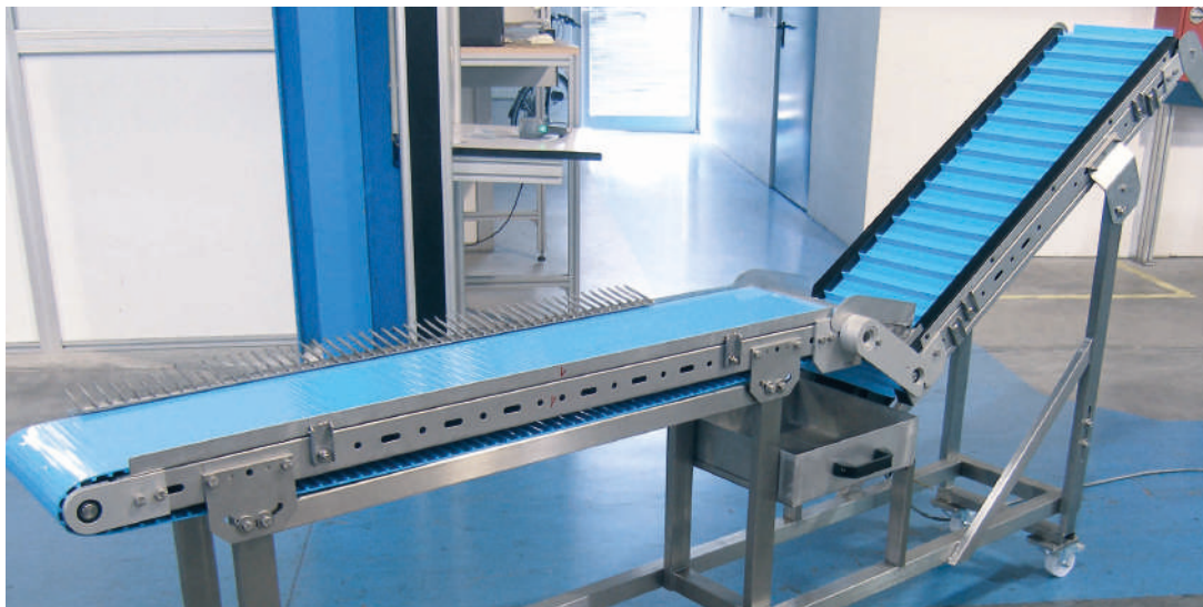
Kombination aus INOX Gurt- und Schräggurtförderer für den Transport von Pralinenkugeln mit Granulat
