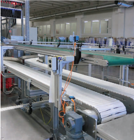
Versaflex SBF A29 als Packtisch in Kombination mit Gurtförderer auf zweiter Ebene
