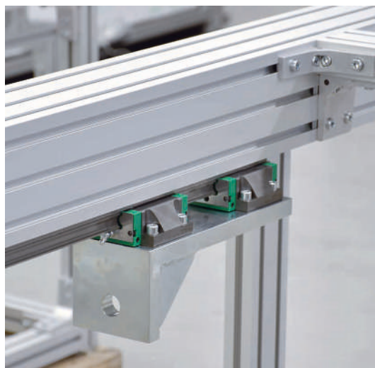
Gestell für Knickversuche anhand von Kugelumlaufführung KU 30.10
