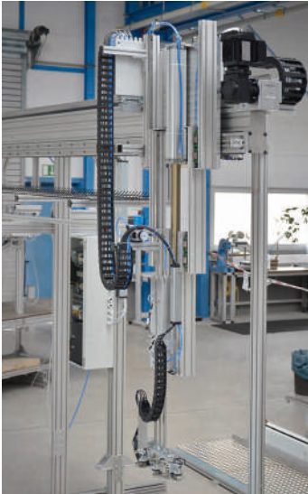
Portalständer mit teleskopierbarer Greifereinheit
