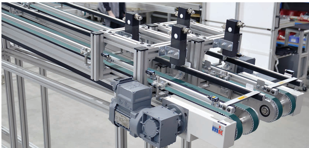
Doppelter Zweistrang-Zahnriemenförderer ZRF-P 2040 mit Vereinzelungseinheit und verstellbarer Steigung
