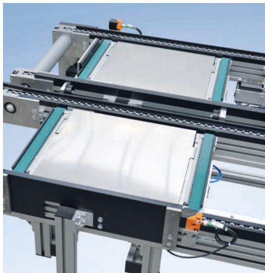
Staurollenkettentransporter SRF-P 2010 als WT-Umlaufsystem mit Hub-Querförderer
