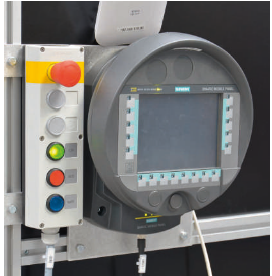
Türanwahl mit Not-Halt Taster und mobiles Bedienpanel
