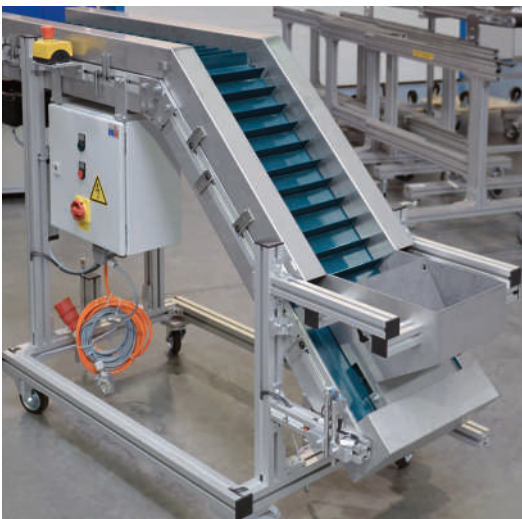
Mobiler KFG-P 2000 Typ K mit Seitenführung SF 9.1 (VA-Blech gekantet) und Übernahmefunnel am Bandanfang inkl. Steuerung
