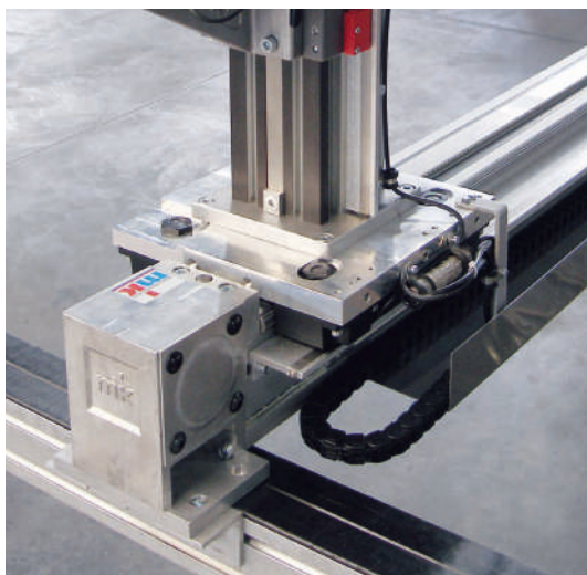
Linearmodul Typ LZR 2005-38.44-30 als direktes Längenmesssystem mit Messkopf am Laufwagen
