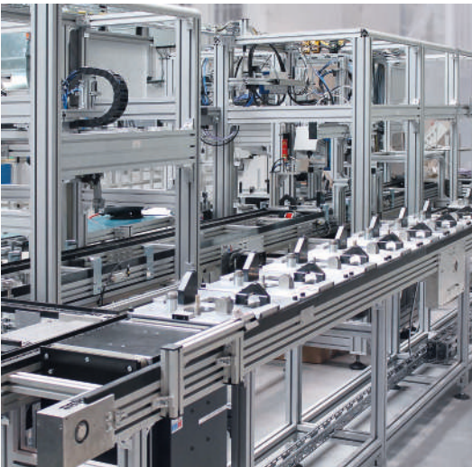
Schlüsselfertiges Werkstückträgersystem Versamove plus mit Montageautomation
