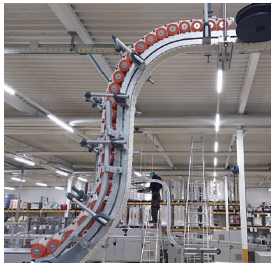
Versaflex SBF mit Anpressrollen für den vertikalen Transport
