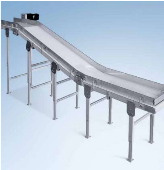
Knickförderer Gurt KFG-P 2000 mit Kopfantrieb AC und Seitenführung, Gurtführung über Längsstollen K10
