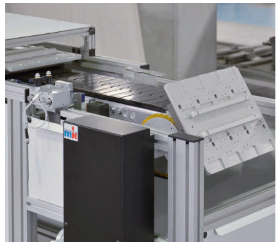
Einstrang SPU mit kundenspezifischer Werkstückträgeraufnahme
