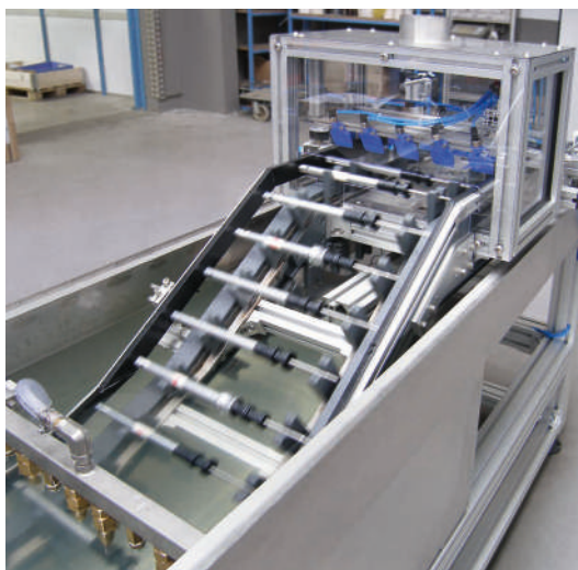
TKU 2040 mit 20° Neigung und Transport durch ein Reinigungsbad
