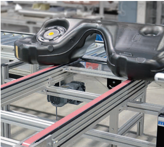
Verkettung ZRF-P 2010 als Abführstrecke für Kraftstofftanks
