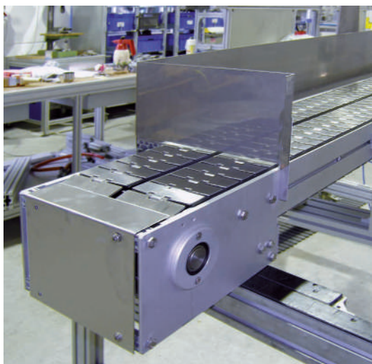
Doppelstrang-Scharnierbandförderer SBF-P 2254 mit robuster Stahlkette
