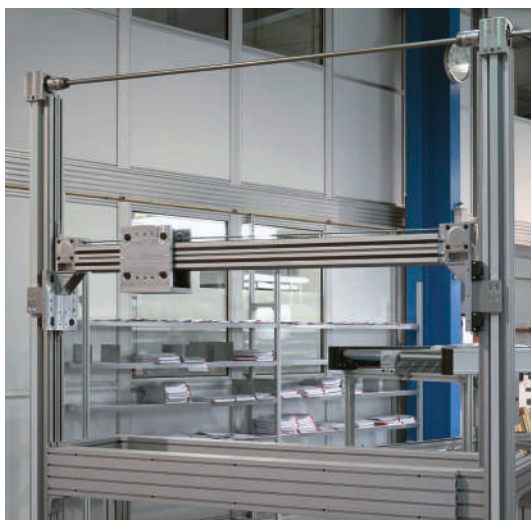
2-Achs Linearmodul aus LZR 2011-38.44.30 mit seitlichem Plattenlaufwagen
