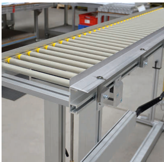
Schwerkraftrollenbahn RBS-P 2066 mit höhen- verstellbarem Ständer und Winkelblech als Seitenführung
