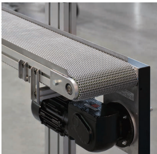
GUF-P2000 mit Kopfantrieb AC mit Runddrahtgliedergurt für Fördergut bis 150°C
