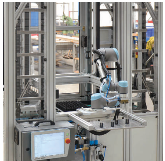
Fertigungszelle mit doppeltem Paternoster- Speicher für Zu- und Abführteile
