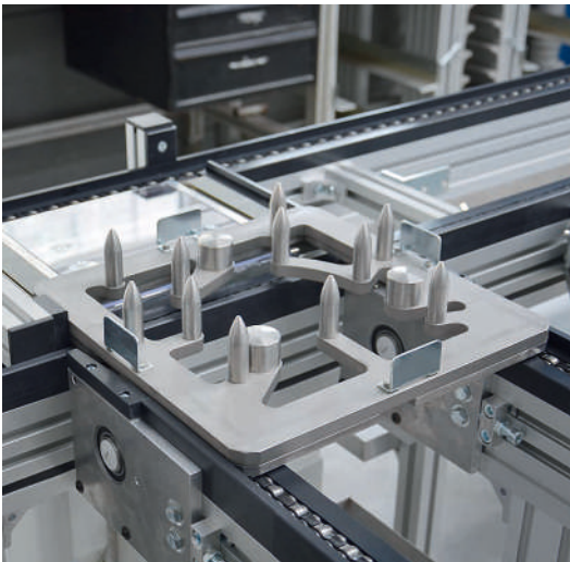
Kundenspezifischer Werkstückträger in korrosionsbeständiger Ausführung für eine Reinigungsanlage
