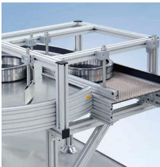
Drehtisch DT-P 2040 mit manuell einstellbarer Ausschleusung für Bauteile
