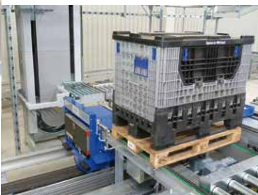
Durch den Einsatz modernster, berührungsloser Strom- und Datenübertragung arbeitet das **SpeedPorter** - Fahrzeug äußerst leise und das auch bei einer Geschwindigkeit von 2,5 m/s.
