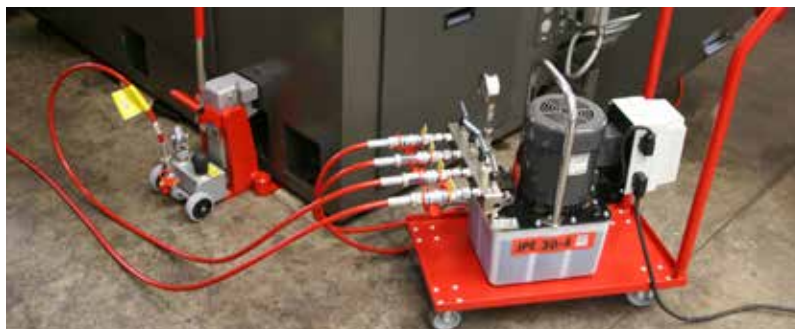
Elektropumpe JPE 30 NVR mit 2 Hebegeräten im Einsatz
