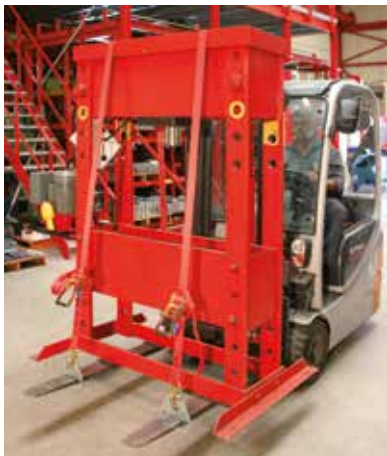
Ladungssicherung mit Gabelklemmen und Spanngurten
