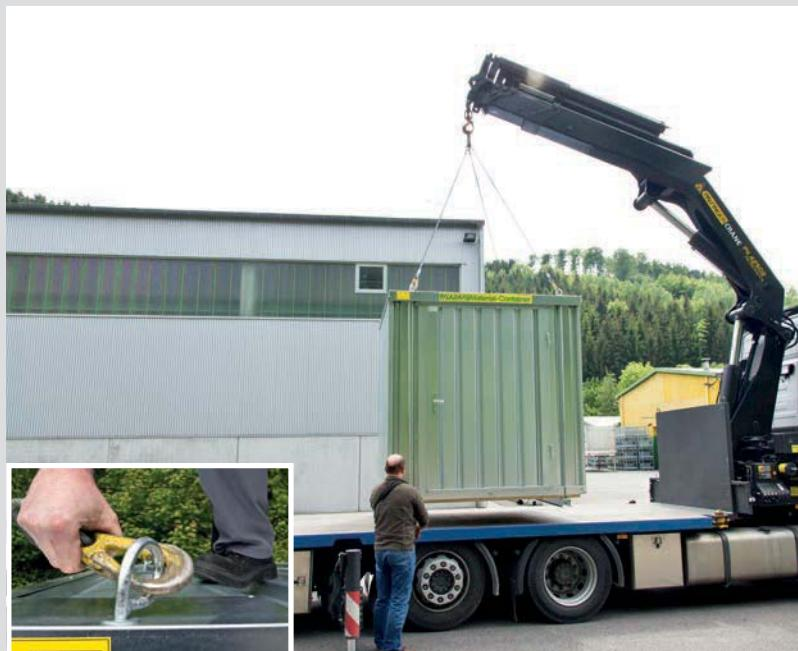
Die Kranverladevorrichtung für das Versetzen im beladenen Zustand besteht aus vier Zugstangen mit Ösen und zwei Unterzügen.
