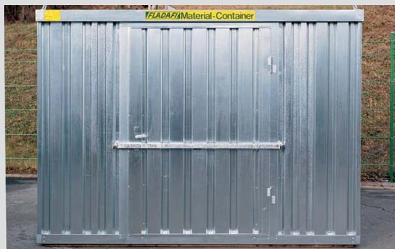
Die stabile Diebstahlsicherung aus verzinktem Formstahl wird mit zwei Diskusschlössern vor der Tür angebracht und verdeckt zusätzlich das Türschloss. Der Diebstahlschutz ist für die 1.300 mm breite Standardtür und die 1.800 mm breite Doppelflügeltür erhältlich.
