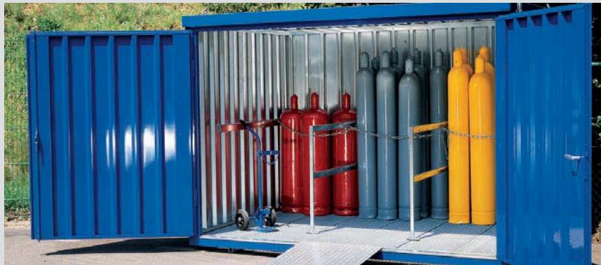
SAFE Gasflaschen-Magazin Typ 366 mit Boden aus Gitterrost, Überfahrbrücke und Außenwandlackierung. Die verzinkten Haltevorrichtungen sind variabel verschiebbar und leicht herausnehmbar. Sie ermöglichen die bedarfsgerechte Aufteilung der Lagerfläche. So kann die Lageraufteilung optimal an den aktuellen Lagerbedarf angepasst werden.
