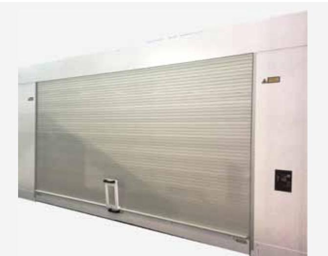
Rolltür an einer Lasermaschine, Breite 4500 mm
