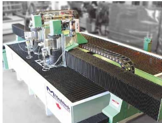
Faltenbälge und Nylatrac-Kunststoff-Energieführungen an einer Wasserstrahlmaschine.
