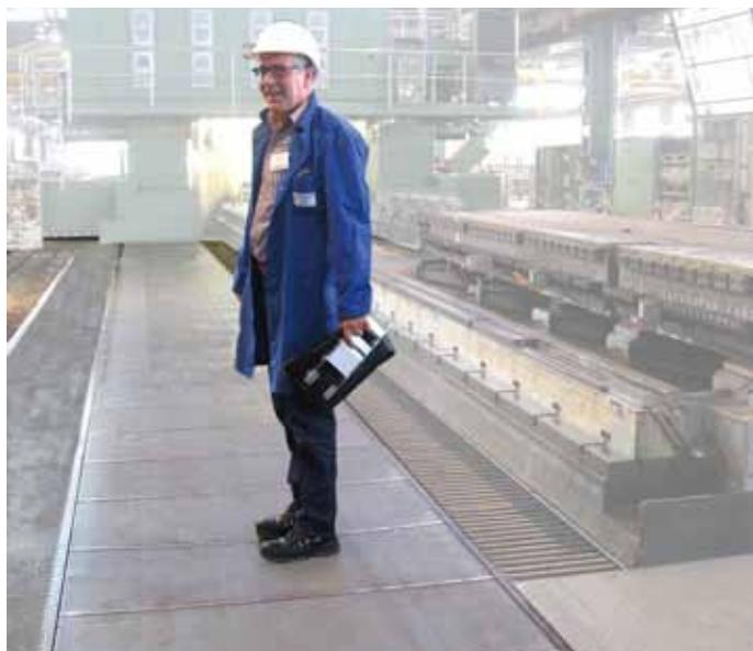
Begehbar Steelflex-Abdeckungen sind praxiserprobt und werden schon seit Jahrzehnten zum Schutz von Personen und Maschinen auf Führungsbahnen und Inspektionsgruben eingesetzt.
