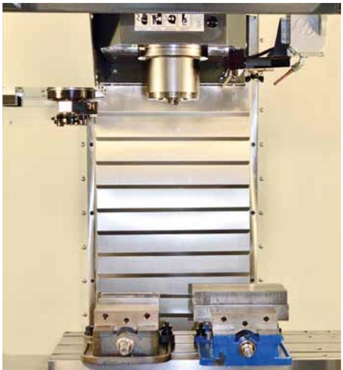
Die leichtgewichtigen Gorplate-Jalousie-Abdeckungen bieten Führungsbahnen, Linearführungen und Maschinenbauteilen einen wirksamen Schutz vor heißen Spänen und Schweißspritzern.
