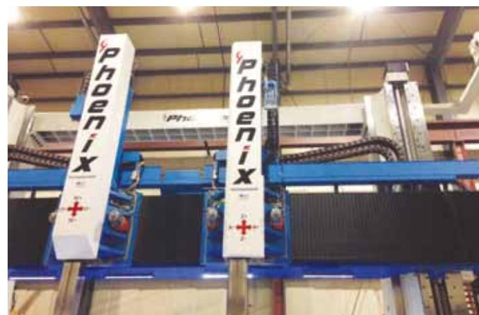
Faltenbälge als Querbalkenabdeckung und Nylatrac-Kunststoff-Energieführungen mit langen Verfahrwegen an einem vertikalen Bearbeitungszentrum.
