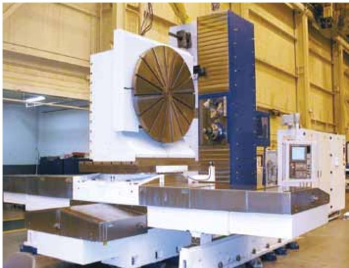
Telaflex-Stahlabdeckungen und Gordillo-Faltenbälge schützen die Führungsbahnen einer Waagerechtbohrmaschine vor Spänen und Kühlflüssigkeiten.
