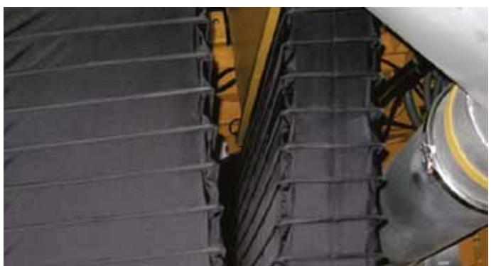
Gorframe-Faltenbälge für Luftkanäle an einem Schwerlastwagen.
