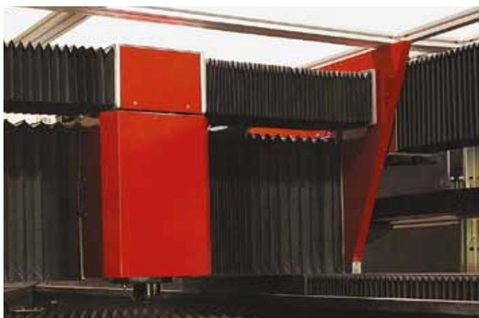
Faltenbalg für Laserstrahlen horizontal und vertikal.
