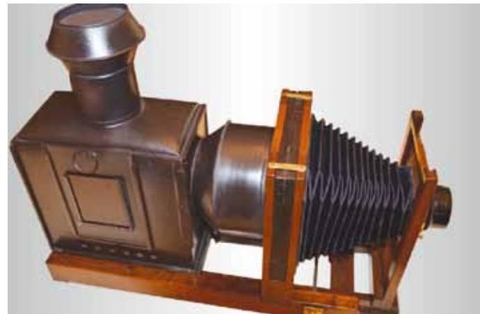
Lichtdichter Faltenbalg an einem restaurierten Vergrößerungsgerät.
