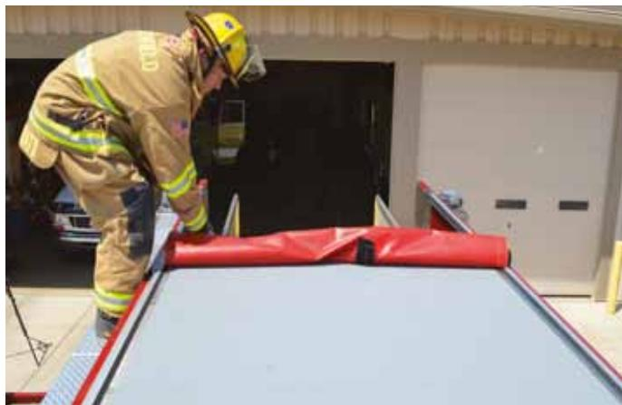
Schwere Schutzrollos können an Schlauchbetten von Löschfahrzeugen als zurückschiebbare Abdeckung montiert werden. Sind die Schläuche nicht im Einsatz, sind die Schutzrollos auch begehbar.
