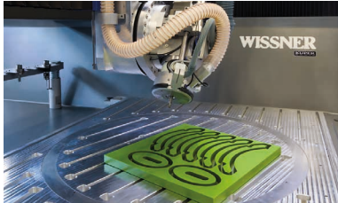
5D Bearbeitung mit Schwenkopf und Drehtischmodul
