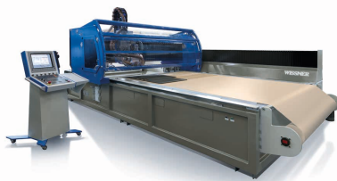
Mitfahrende Haube und Teiletransport durch Papiervorschub
