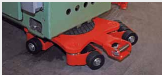
Kreiselfahrwerk JKB im Einsatz Revolving trolley JKB in action
